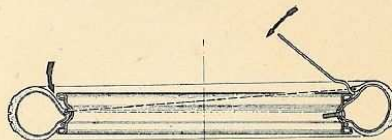
Obr. 17. Řez ráfem a pneu — montáž pláště
