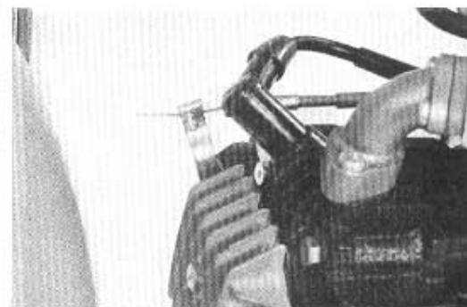
Afb. 47. — KLEP LICHTER HEVEL AFSTELLING.
