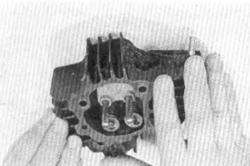
Afb. 55. — CONTROLE VAN DE CILINDERKOP OP DE VLAAPLAAT.
