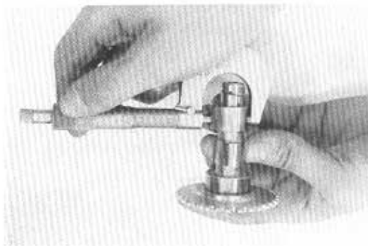
Afb. 72. — HET METEN VAN DE NOKKENAS.
