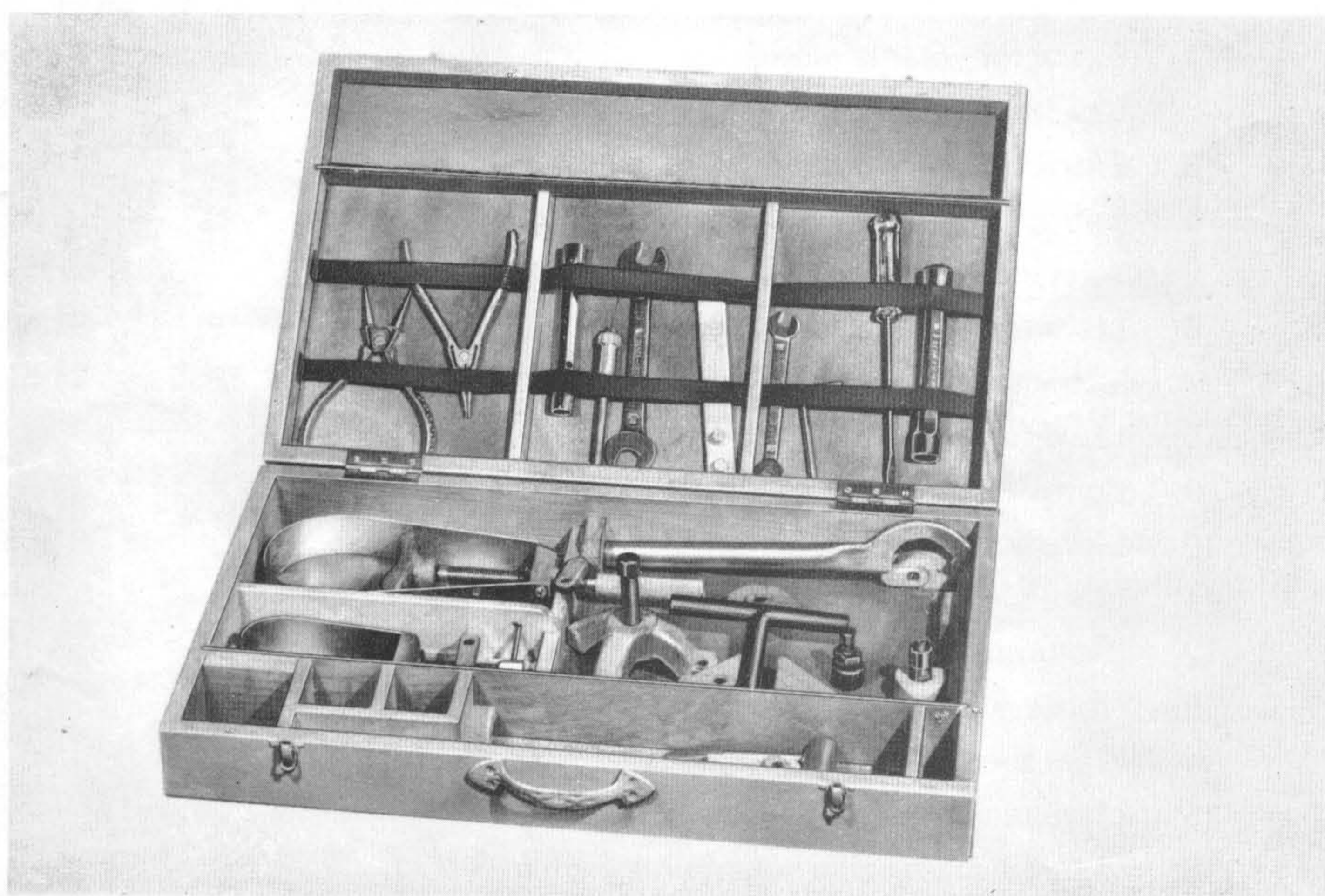
2. — CAJA DE HERRAMIENTAS ESPECIALES PARA DESMONTAR Y MONTAR LOS MOTORES DERBI 49 c. c.
